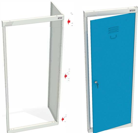
\*В варианте сборки на винтах передняя панель шкафа ШРЭК 21-530 и МД ШРЭК 21-530 поставляется с предустановленной на карточных петлях дверью.
